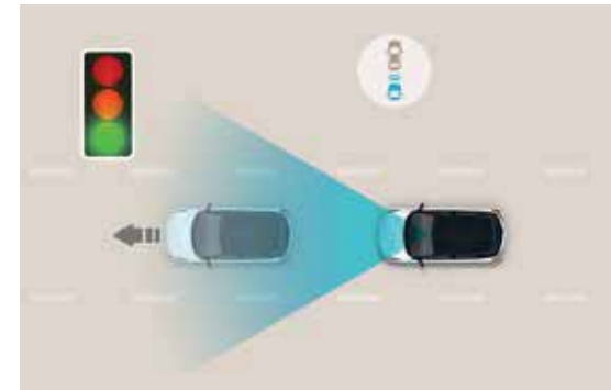
Leading Vehicle Departure Alert (LDVA) Waarschuwt de bestuurder als een voorligger wegrijdt en de bestuurder niet tijdig reageert, bijvoorbeeld in files of voor een verkeerslicht.
