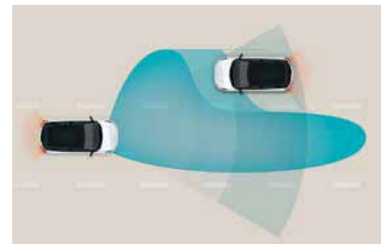
High Beam Assist (HBA) De grootlichtassistent detecteert 's nachts zowel naderende voertuigen als voertuigen in hetzelfde rijvak voor u. Door automatisch de grootlichten in en uit te schakelen, verhoogt dit uw veiligheid en zichtbaarheid in het donker.
