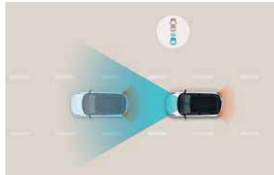
Forward Collision-avoidance Assist (FCA) Via de camera vooraan en de radarsensor waakt het FCA-systeem over het verkeer voor je. Als het een mogelijke aanrijding met een voertuig of voetganger voor je detecteert, waarschuwt het systeem je en zal de wagen indien nodig vanzelf vertragen of stoppen.
