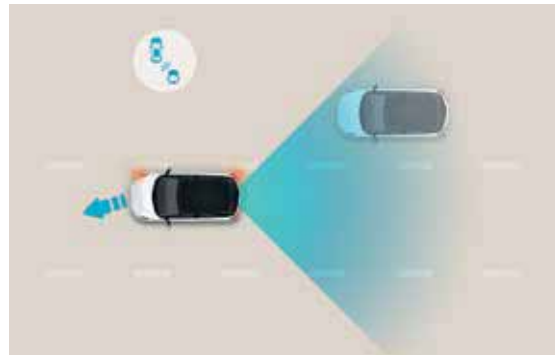
Blind Spot Collision-avoidance Assist (BCA) Met 2 radarsensoren onderaan in de achterbumper waarschuwt het systeem je visueel voor verkeer in je dode hoek. Als je op dat moment je richtingaanwijzer aanzet, krijg je een geluidssignaal en remt de wagen om een aanrijding te voorkomen.
