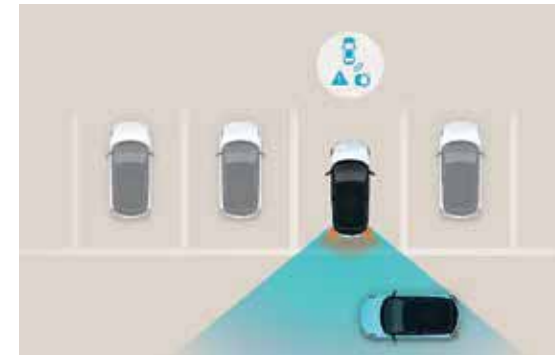
Rear Cross-traffic Collision-avoidance Assist (RCCA) Bij het uitrijden uit een nauwe parkeerplaats vermindert dit systeem het risico op een aanrijding. Via 2 radarsensoren achteraan krijg je een waarschuwing bij naderend en remt de wagen automatisch indien nodig.
