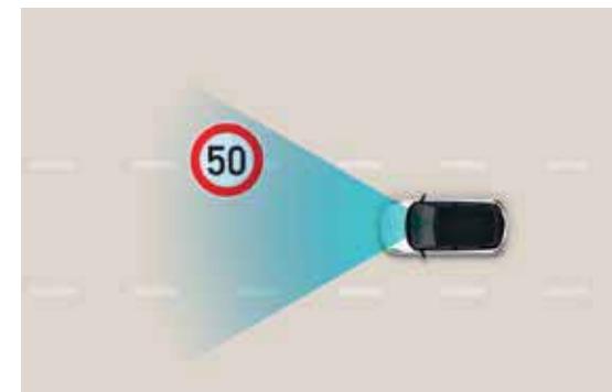
Intelligent Speed Limit Assist (ISLA) Waarschuwt met akoestische en visuele signalen als de snelheidslimiet wordt overschreden. In combinatie met de manuele snelheidsbegrenzer of Smart Cruise Control kan ISLA de snelheid zelfs automatisch aanpassen.
