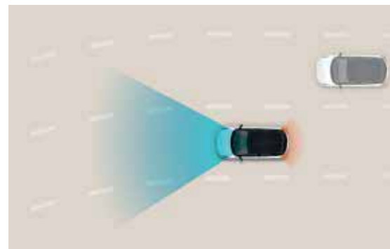
Navigation-based Smart Cruise Control (NSCC) Via het state-of-the-art navigatiesysteem anticipeert het systeem op bochten of rechte stukken die eraan komen en past de snelheid automatisch aan voor een veiliger rijervaring
