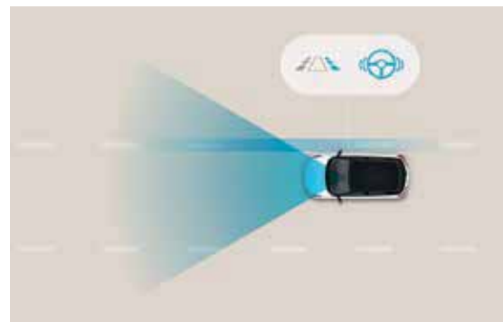
Lane Keeping Assist (LKA) De standaard rijstrookassistent gebruikt de camera vooraan om wegmarkeringen te monitoren. Wanneer de assistent merkt dat de wagen onbedoeld afwijkt van zijn rijvak, waarschuwt hij je of stuurt actief bij om de wagen in zijn rijvak te houden.
