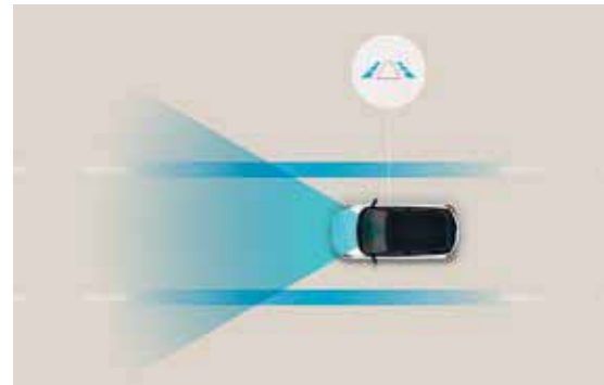
Lane Following Assist (LFA) Dit systeem zorgt ervoor dat de wagen in het midden van zijn rijbaan blijft aan snelheden tussen 0 en 180 km per uur, zowel op de snelweg als in de stad.
