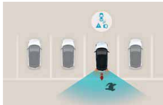
Parking Collision-Avoidance Assist-Reverse (PCA-R) Manoeuvreer nog veiliger achteruit in smalle parkeerplaatsen. Als er een mogelijke aanrijding met voetgangers of objecten wordt gedetecteerd, waarschuwt het systeem je en remt de auto automatisch af.
